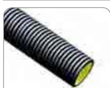
Lunghezza barre: 6 m - Manicotto di giunzione a corredo - Conforme alla normativa CEI EN 50086-2-4/A1 marchio IMQ - Colore esterno: grigio - Colore interno: giallo - Resistenza allo schiacciamento 750N, deformazione del diametro interno pari al 5% - Marcature ENEL
